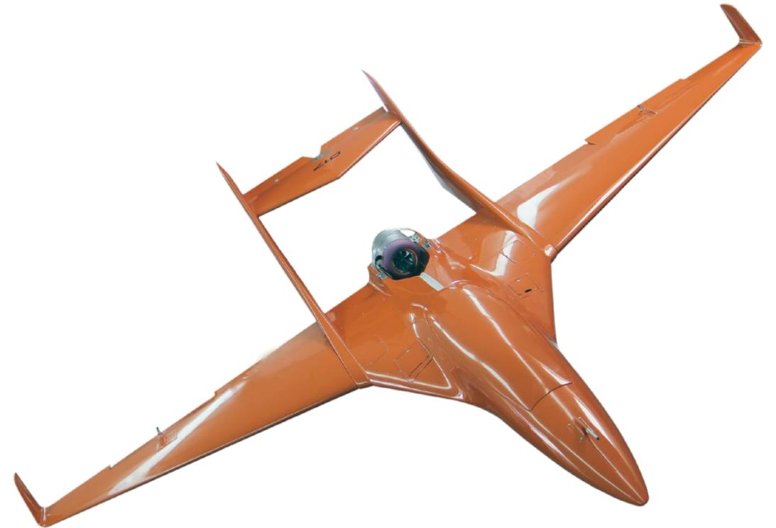
Беспилотный авиационный комплекс «Беркут-ВМ» состоит из наземной станции управления (НСУ), комплекта беспилотных самолётов «Беркут», выполняющим функции роботизированной воздушной мишени и пусковой установки.
